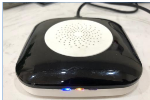
黄灯长亮：正常工作，已连上服务器，可以远程控制
